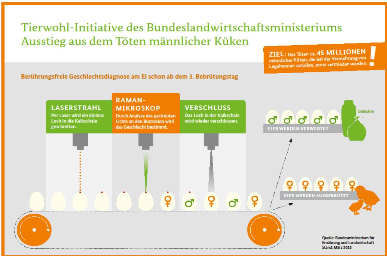
Abbildung 1 Ablauf der berührungsfreien Geschlechtsdiagnose am Ei<sup>22</sup>
